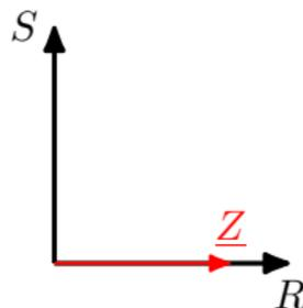
$\varphi = 0$  illustre que  $u$  et  $i$  sont en phase quelle que soit la fréquence.
